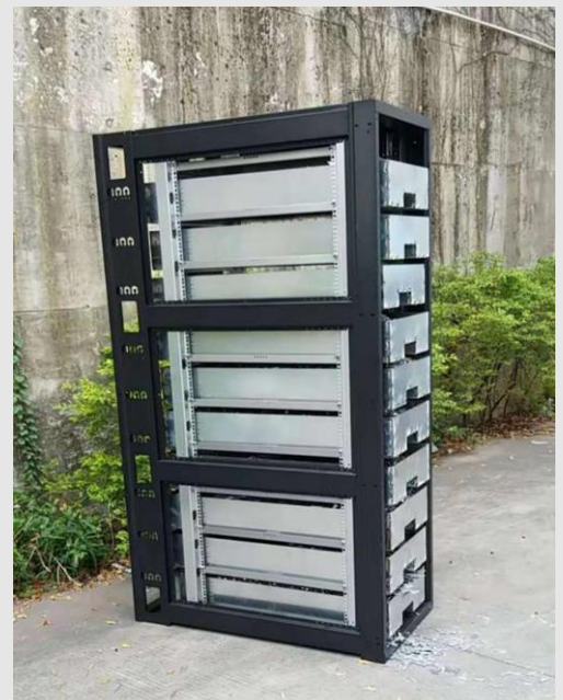
承重测试, 每个铁箱放置 220KG 铁片, 合计重量 2200KG
